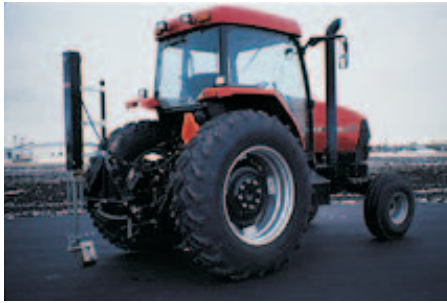
Figura 4.5 • Tractor com sistema de recolha de amostras de solo
