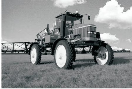
Figura 4.15 • Pulverizador VRT acoplado a tractor com antena de receptor GPS
