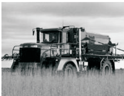
Figura 4.14 • Distribuidor de adubo pneumático com sistema VRT
