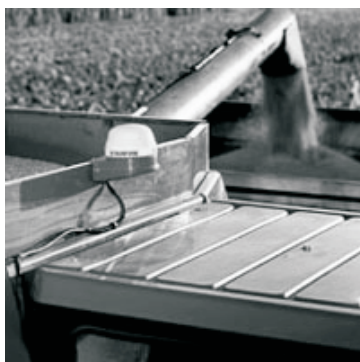
Figura 4.11 • Antena GPS numa ceifeira-debulhadora
