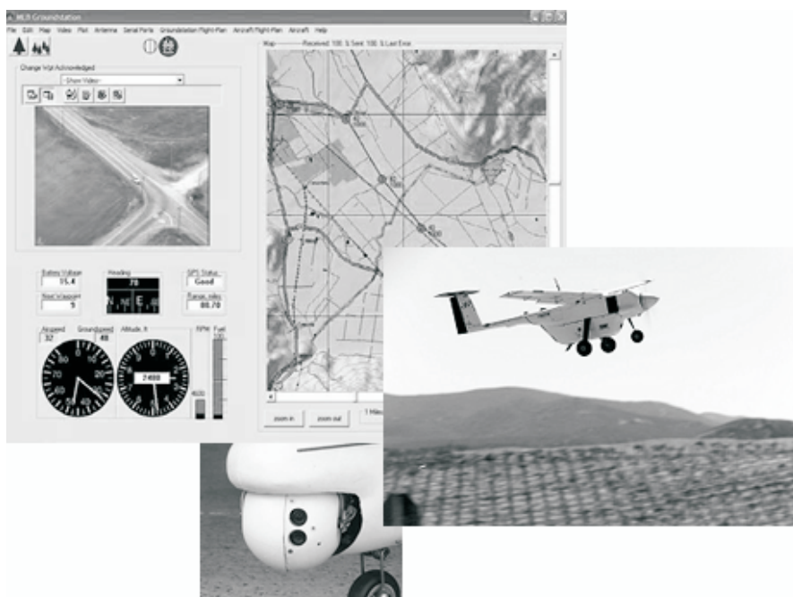
Figura 6.5 • UAV voando sobre campo agrícola, interface de controlo remoto e pormenor dos dispositivos de captura de imagem
